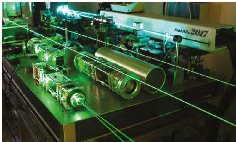
12. ábra. Az SZFKI-ban kifejlesztett lézeres Doppler-anemométer laboratóriumi változata
