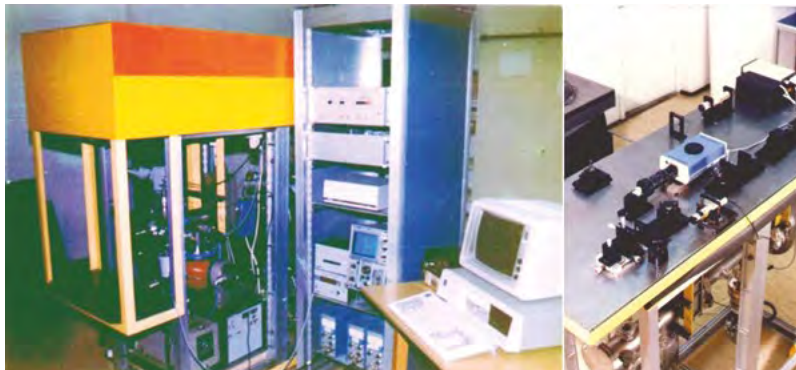
8. ábra. A LézerIonizációs RepülésIdő-TömegAnalizátor (spektróméter), a LIRITA (balra) és annak optikai rendszere (jobbra)
