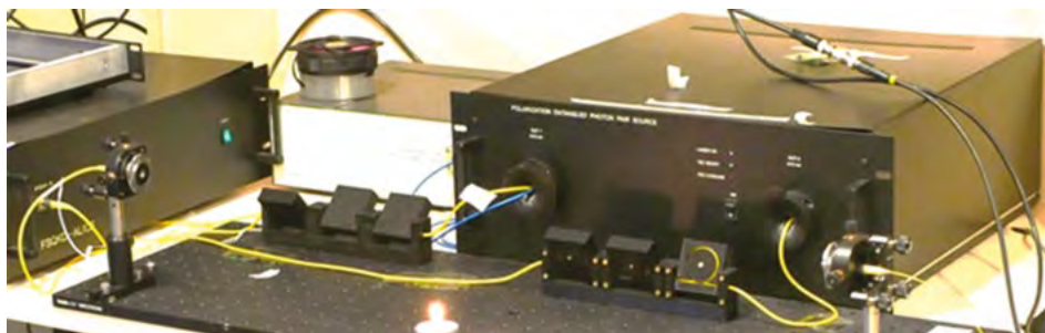
3. ábra. A csoport által fejlesztett polarizációban összefonódott fotonpárforrás működés közben a BME Hálózati Rendszerek és Szolgáltatások Tanszékén
