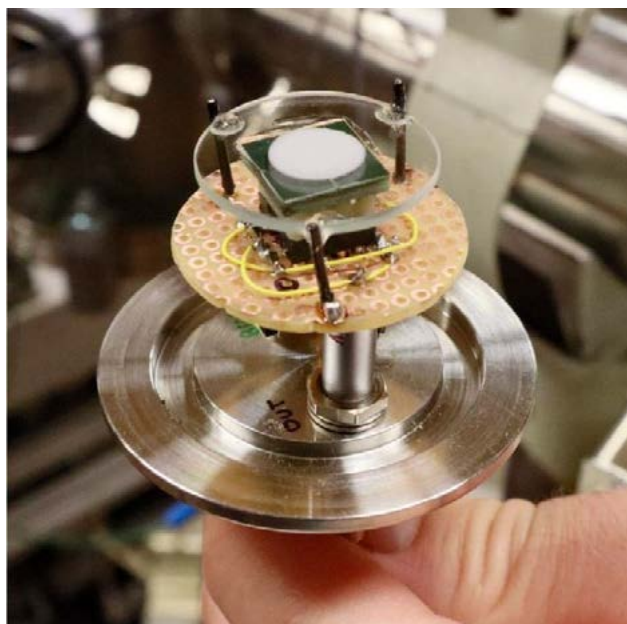
3. ábra. Perovszkit vékonyréteges fotoelektron-sokszorozóval egybeépített detektor prototípusa
