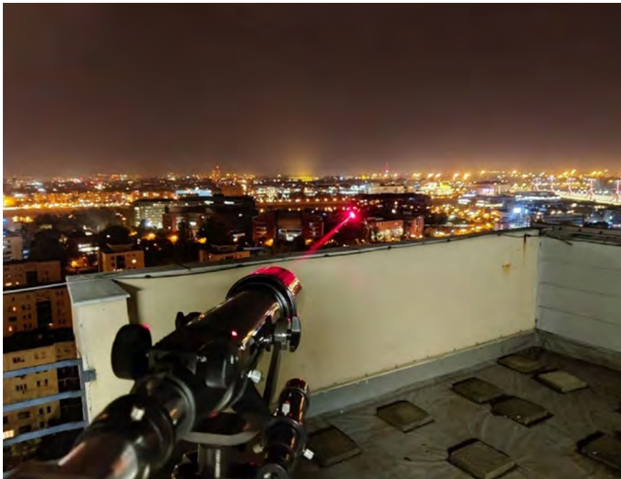
2. ábra. Óraátviteli rendszerkísérlet a BME I épülete és a Schönherz kollégium között
