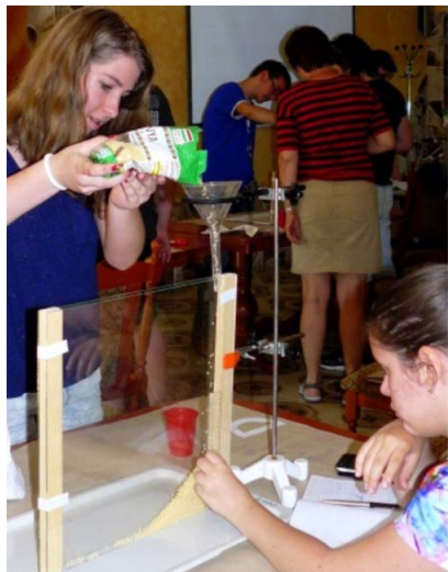
4. ábra. Tanulói mérések: granulált anyagok rézsűszögének mérése (balra) hidrosztatikai feketedoboz (jobbra).
