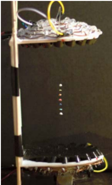
1. ábra. Ultrahangos levitátor (balra) és az eszközben kialakuló átlagos nyomáshullám (jobbra).
