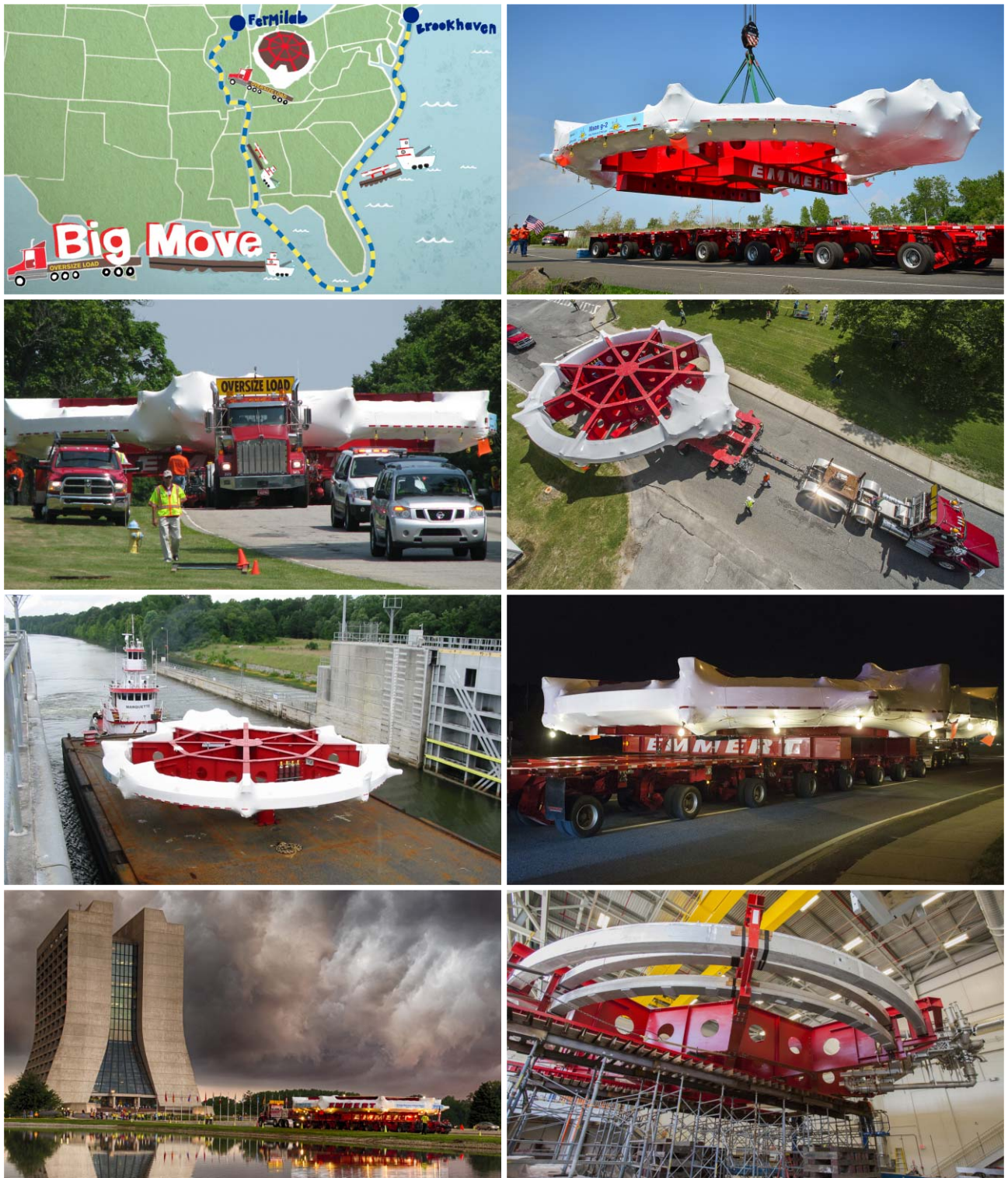
7. ábra. A müöngyűrű szállítása a New York melletti Brookhaven Nemzet Laboratóriumból a Chicago közelében levő Fermilabba vízen és közúton. Az utakon éjjel közlekedtek, és gyakran kellett leszerelni lámpaoszlopokat és útjelző táblákat.
