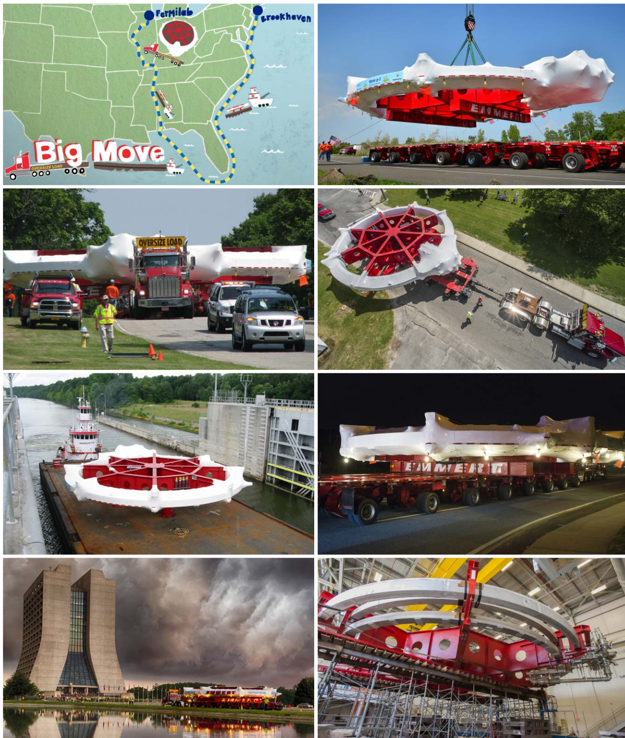
7. ábra. A müönggyűrű szállítása a New York melletti Brookhaven Nemzet Laboratóriumból a Chicago közelében levő Fermilabba vízen és közúton. Az utakon éjjel közlekedtek, és gyakran kellett leszerelni lámpaoszlopokat és útjelző táblákat.
