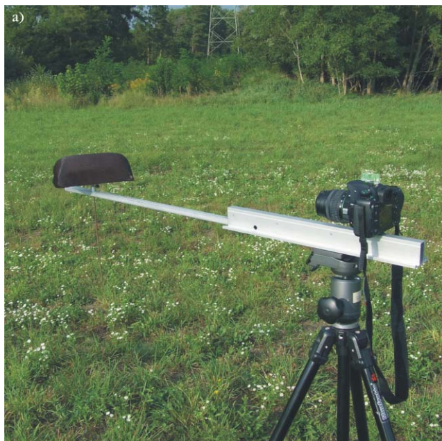
1. ábra. a) A lómodellel végzett képalkotó polarimetriás mérés eszköze. A félhenger alakú, sötétbarna lóbbőrrel bevont lómodellel a polariméter előtt rögzítettük a modell függőleges tengelye körül forgathatóan. b) A mérési elrendezés geometriája felülnézetből. \beta : a polariméter vízszintes optikai tengelyének az antiszoláris meridiánnal bezárt szöge. \delta : a modell vízszintes hossztenegelyének a polariméter optikai tengelyével bezárt szöge.
