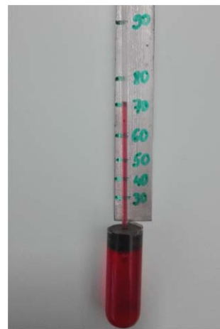
7. ábra. A kaloriméterben kalibrált víz hőmérő skálája 30–90 °C hőmérséklet-tartományban.
