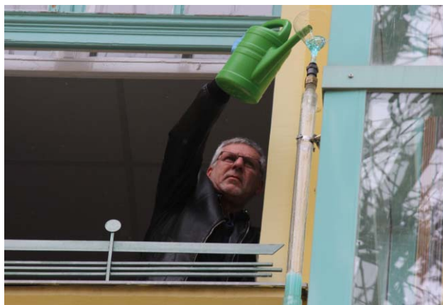
3. kép. A Torricelli-cső feltöltése (fotó: Z. S.).
