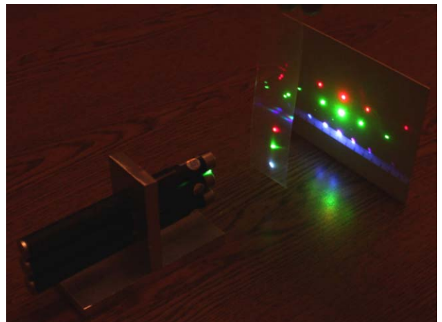
5. ábra. Az elhajlás hullámhosszfüggésének bemutatása lézermutatók segítségével.
