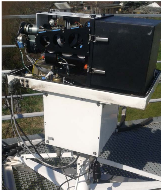
8. ábra. A Budapesten működő (152-es számú) Brewer-spektrofotométer.
