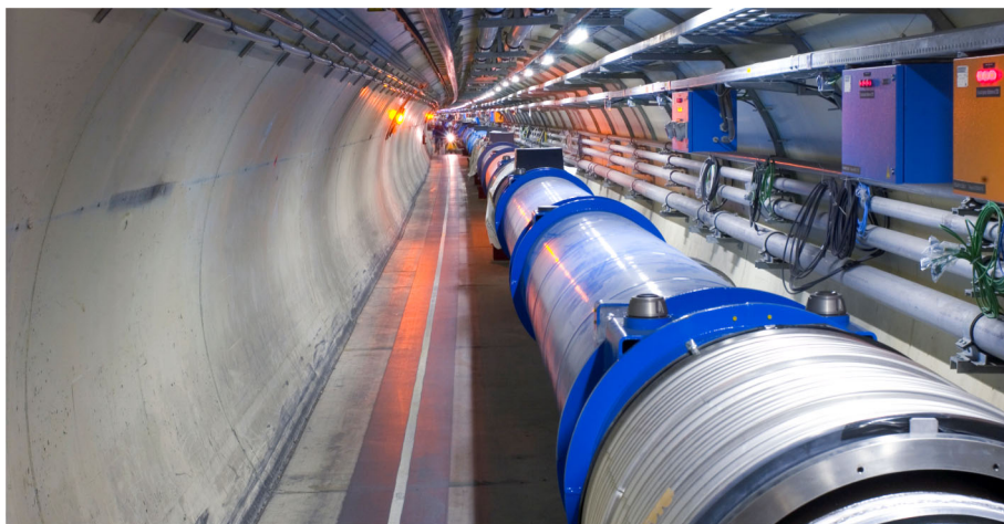
2. ábra. Az LHC alagútja a mágnesekkel.
