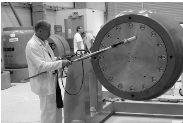
3. ábra. A betöltött VPVR/M konténer sugárvédelmi ellenőrzése.
