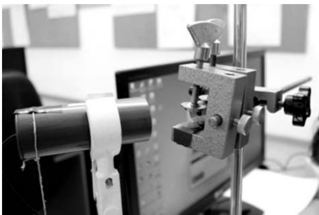
A mérési összeállítás, balra a GM-cső
