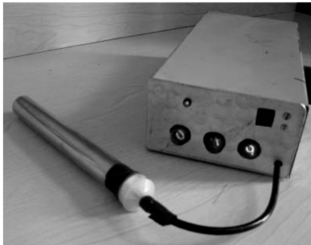
A Geiger-Müller-számláló háttérsugárzás mérése közben.
