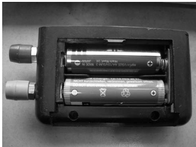
9. ábra. Szembekapcsolt elemekkel kisfeszültséget állíthatunk elő
