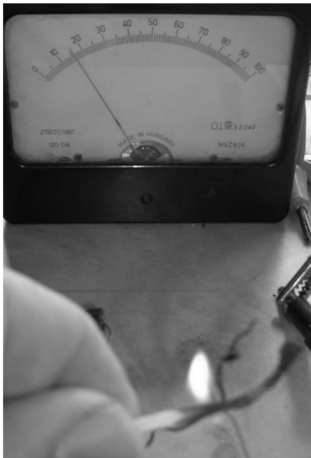
3. ábra. A termoelem működése
