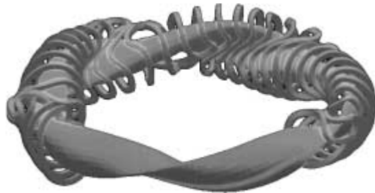
3. ábra. A Németországban építés alatt álló Wendelstein 7-X szupravezető sztellarátor modultekerceinek számítógépes képe (az előtérben levő tekercesek nélkül). Ezt a tekercesrendszert körülveszi még egy közös toroidális tekerces. A tekerceseken belüli szalag a plazma. A csavarodó mágneses teret a tekerceseken csavarvonalban végigfutó alak adja. A berendezés átmérője körülbelül 10 m. (A kép közreadásáért köszönet a Max-Planck-Institut für Plasmaphysiknek.)
