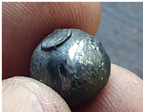
18. kép: A cső koptatásának nyomai a pisztolygolyón
