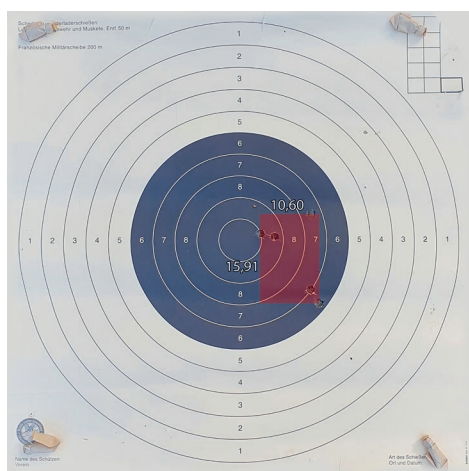
10. kép: Muskéta lövéseinek szórásképe 50 m-en villáról tüzelve, apostolokból töltve
