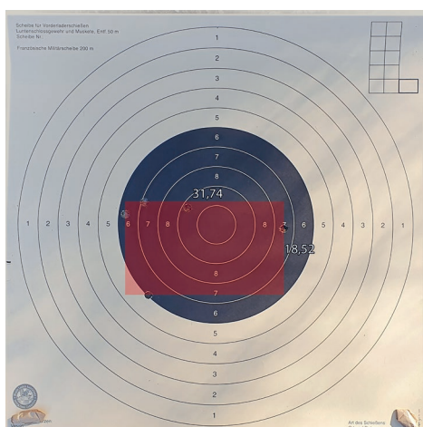
9. kép: Muskéta lövéseinek szórásképe 50 m-en villáról tüzelve, papírtölténnyel töltve
