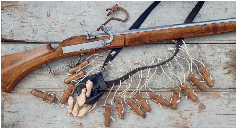
6. kép: Lőkísérletekhez előkészített muskéta apostolokkal és töltényekkel
