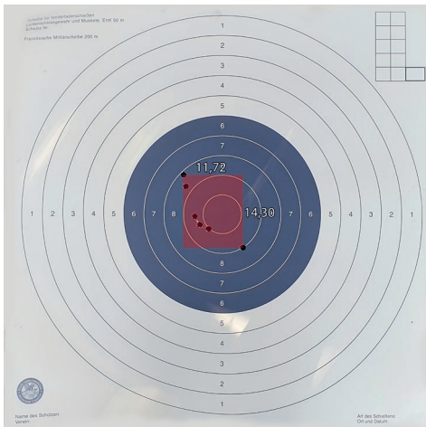
14. kép: A keréklakatos pisztoly szórásképe 10 m-en gömblövedékekkel
