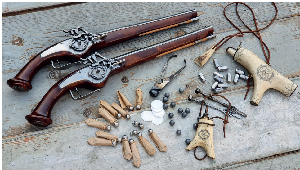
13. kép: Lőkísérletekre előkészített keréklakatos pisztolyok és töltényeik
