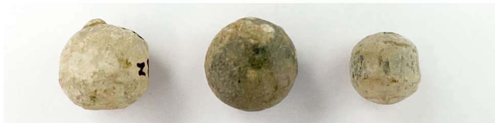
13. kép: A kilövés nyomai a HM HIM Hadirégészeti Gyűjteményének lövedékein. A lövedékeken jól felismerhető a „banding” jelenség, vagyis a cső koptató hatására kialakuló teljes vagy részleges körbefutó öv (Fotó: Kulcsár Viktor)
