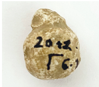
5. kép: Öntőcsúcsos golyó a HM HIM Hadirégészeti Gyűjteményéből. A lövedék öntése után nem távolították el az öntecset (Fotó: Kulcsár Viktor)
