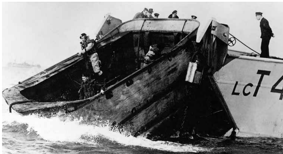
7. kép: Egy Sherman DD indítása az LCT 461 jelzésű LCT(3)-ról (IWM, ADM 1036). A képen látható harckocsipéldány már egy ellenállóbb, DD Mk. II ponyvaszerkezetet kapott.
