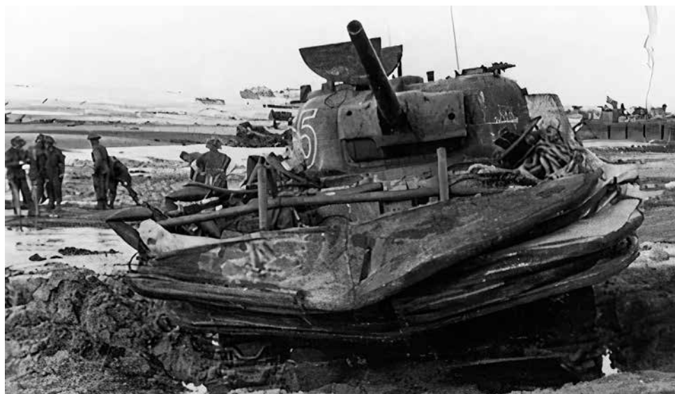
11. kép: Egy Gold partszakaszon elakadt Sherman DD (Bovington). A parton az ellenséges tűz és az aknák mellett a puha iszap és a marasztaló sár is „szedett áldozatokat”.
