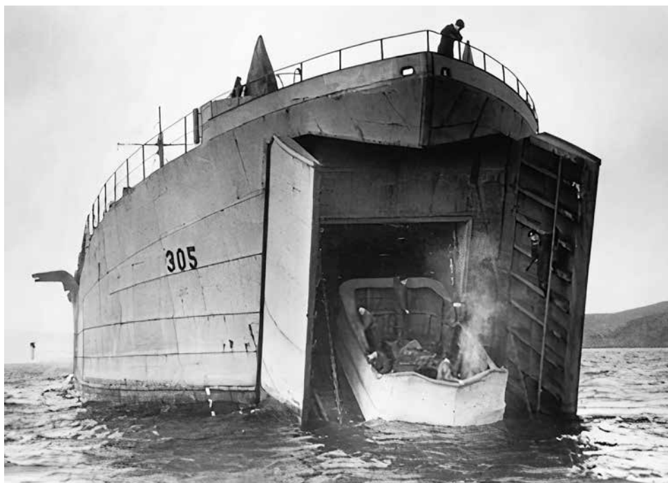
4. kép: Egy Valentine DD indítása egy LST(2)-es partraszálló hajóról (Bovington). A magasabb Sherman DD már nem fért át a csapóajtón
