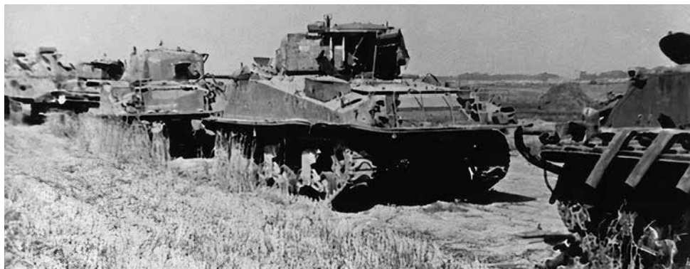
14. kép: Sherman DD harckocsik a franciaországi harcok szünetében. Jól látszik, hogy csak a ponyvaszerkezet gumitömlői, vagy csak annak tartóváza maradt meg, miután a kezelők eltávolították az addigra általuk feleslegesnek ítélt kiegészítőket (Bovington).
