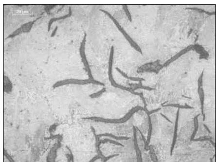
7. ábra. Az agyúgolyó mikroszerkezete nagyobb nagyításban
